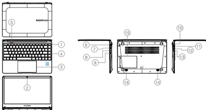
1. Botón de encendido: presiónelo hacia abajo para encender o apagar el dispositivo. También puede dejar que la computadora entre en modo de suspensión a través de este botón o despertar desde el modo de suspensión.
